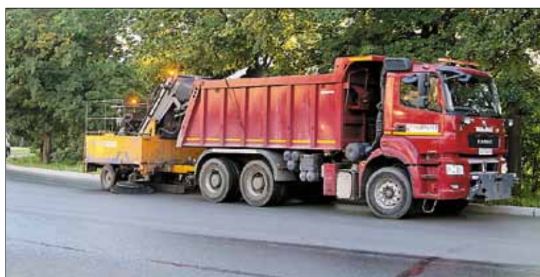
■ На подметально-уборочной машине установлен полный комплекс оборудования для сбора дорожной грязи и пыли
